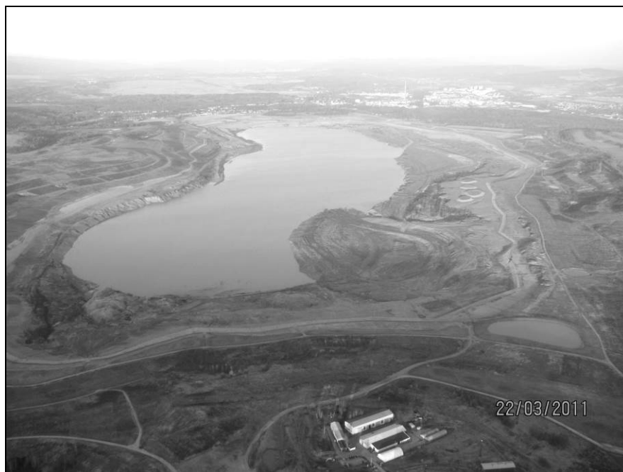
Obrázek 74 Napouštění jezera Medard, které vzniklo zatopením povrchového lomu Medard a Libík. Jezero bylo napouštěno kanálem z řeky Ohře a důlní vodou. (zdroj: Sokolovská uhelná)
