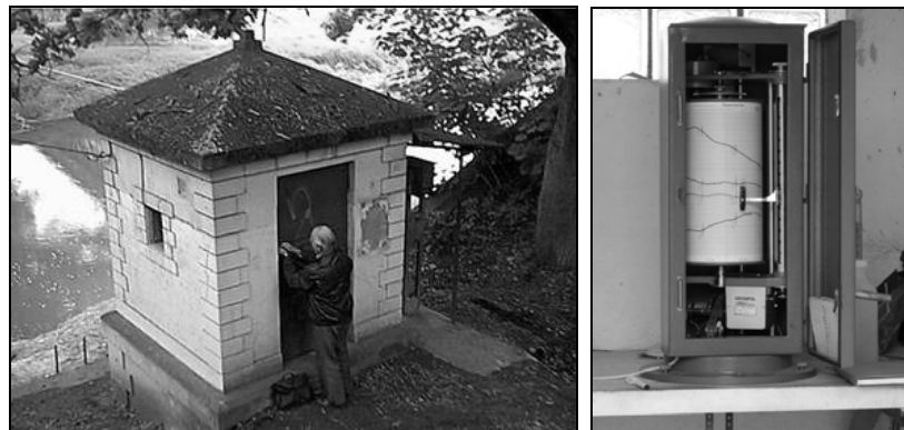
Obrázek 31 Limnigrafická stanice a detail limnigrafu (foto: R. Pavelková Chmelová 2010)
