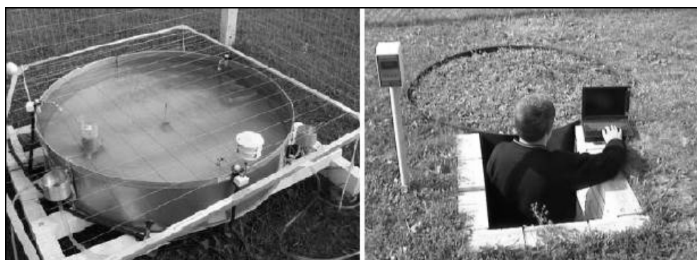
Obrázek 21 Výparoměr a lyzimetr (zdroj: iginstrumentos.com.ar; ČHMÚ)
