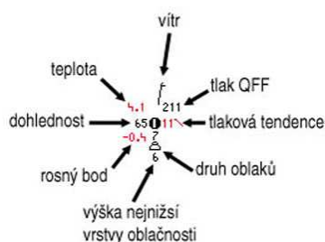
Obř. 54: (Zjednodušené) Schéma staničního kroužku
