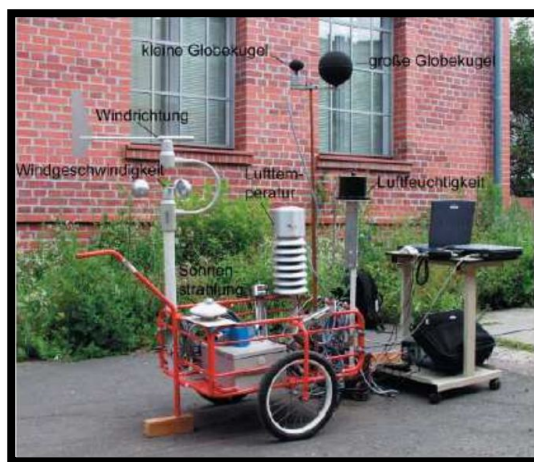
Obr. 3 Mobilní systém pro hodnocení oblasti městského klimatu města Kassel (Katzschner, 2006)
